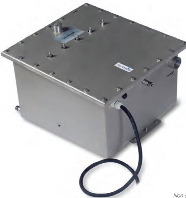
**Pro-Lift** è una unità di pompaggio professionale, necessaria nel caso in cui le acque di scarico non abbiano la dovuta pendenza per raggiungere il serbatoio di raccolta. Pro-Lift è realizzata in acciaio INOX, ed è completamente stagno IP68. Grazie a queste caratteristiche, può essere installato in qualsiasi ambiente, nel rispetto delle normative sulla sicurezza.
