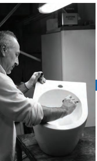
Un nuovo progetto nasce sulla carta nel nostro ufficio tecnico dove l'idea, prima abbozzata, viene **computerizzata in 3D** fino a diventare un prototipo che viene testato e valutato come se fosse un wc in ceramica.
