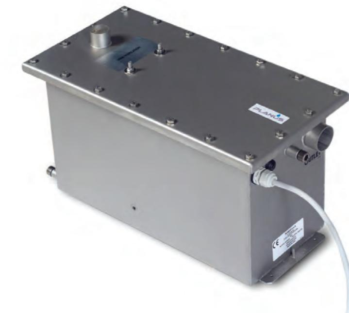
**Pro-Lift** è una unità di pompaggio professionale, necessaria nel caso in cui le acque di scarico non abbiano la dovuta pendenza per raggiungere il serbatoio di raccolta. Pro-Lift è realizzata in acciaio INOX, ed è completamente stagno IP68. Grazie a queste caratteristiche, può essere installato in qualsiasi ambiente, nel rispetto delle normative sulla sicurezza.
