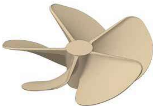
Elica di superficie per scafi plananti pesanti ( surface piercing propeller for heavy planing vessels )
